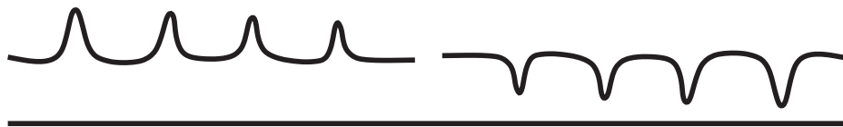
Figuur 4.1 – Twee identieke textuurspectra, maar met verschillende akoestische eigenschappen
