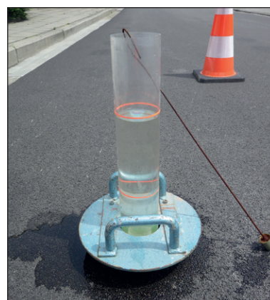
Figuur 5.6 – Meting van het waterafvoerend vermogen
