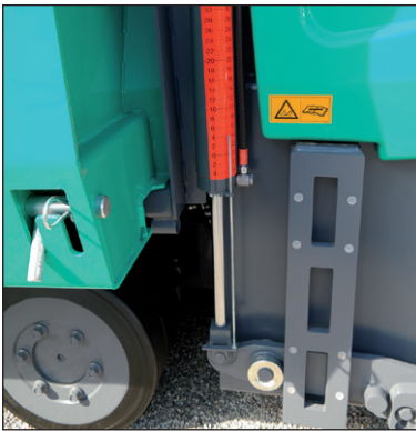
Figuur 1.20 – Bevestiging van de trekarm en nivelleercilinder
