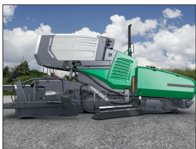
Figuur 1.11 – Asfaltspreidmachine met ingebouwde sproeibalk
