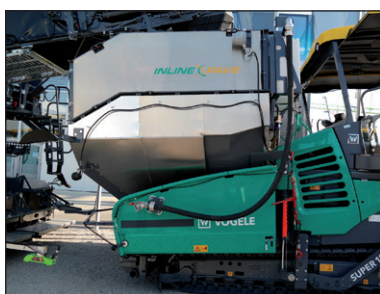
Figuur 1.55 – Extra hopper op de asfaltspreidmachine
