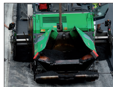
Figuur 3.18 – Naar binnen gekantelde zijschotten van de hopper
