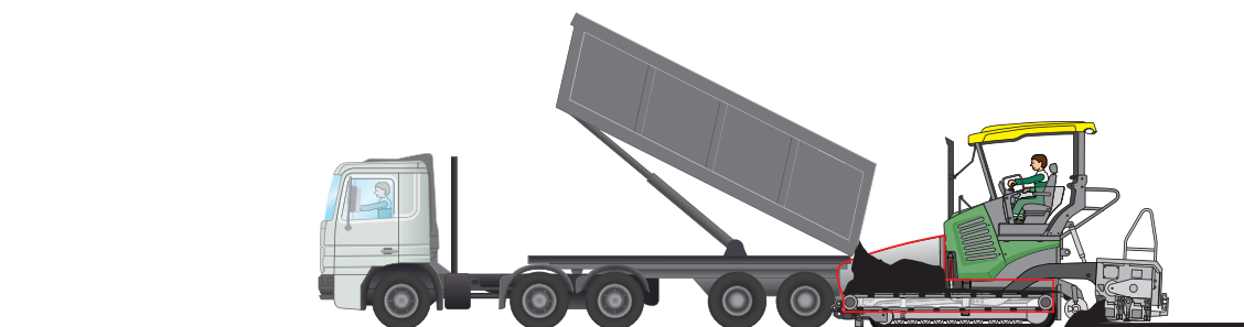
Figuur 3.17 – De asfaltspreidmaschine duwt tegen de vrachtwagen tijdens het lossen
