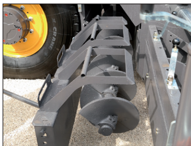
Figuur 1.31 – Wormtunnelplaten (links van de spreidworm) en voorafstrijker (rechts)
