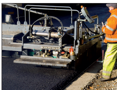
Figuur 1.41 – Opschroefbaar aanbouwdeel met een uitschuifbaar eindstuk
